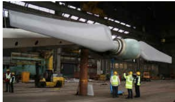
L'hélice de 16m du SeaGen dans l'usine de Harland et Wolff à Belfast
